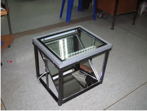
รูปภาพที่ 5 เครื่องวัดแรงกดที่เท้า Podoscope 16
